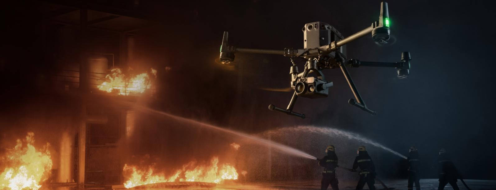
全天候多光旗艦負載 Zenmuse H30 系列, 整合廣角相機、變焦相機、熱成像相機、雷射測距儀和近紅外線補光五大模組, 同時應用尖端智慧演算法, 全面提升感應與成像能力, 突破晝夜視覺侷限, 輕鬆勝任公共安全、能源巡檢、水利林業等領域的作業任務。
